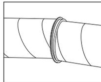
Das zu montierende Rohr mit der Unterseite seines Flansches in die Spannschelle einlegen.
