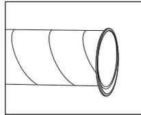
Spannschelle mit Dichtung (\*) über den Rohrflansch am Ende des montierten Rohres bzw. Formstücks hängen.
